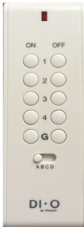
Télécommande de la prise 220V au plafond
